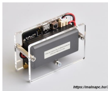
5. ábra Az elemek ennél a típusnál csak a tartó lecsavarása után érhetőek el.
